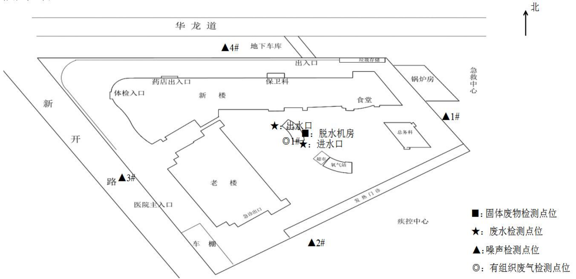
图 4.1 验收监测点位（有组织废气、噪声、废水、固体废物）
