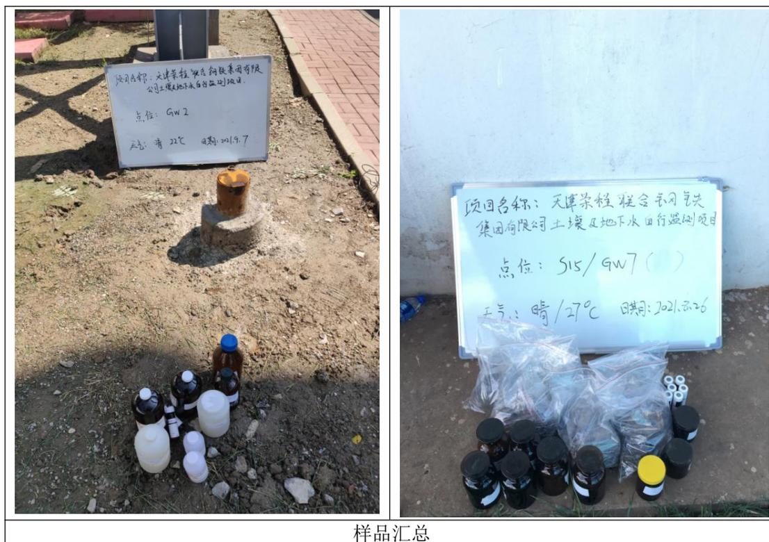
图 5.5 洗井及地下水样品采集
